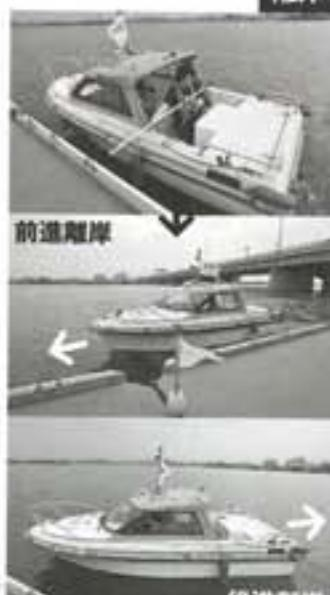
岸への進入角度は約30度。早めにエンジンを中立にして、慣性で岸に近づく。船が止まったら、最後はポートフックを使って船を岸に強く押し出す。船尾がぶつかる危険があるので、後進離岸よりも前進離岸のほうが少し難易度が高い。
